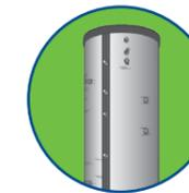
Multifunktionspeicher für Heizung und Warmwasser, speziell für Wärmepumpen entwickelt · innenliegendes Trinkwasserwärmetauschersystem aus Edelstahl · durch eine Trennscheibe werden bedarfsgerecht thermisch getrennte Zonen für Warmwasserbereitung und Heizung geschaffen
